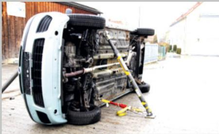
**Stabilisieren von verunfallten PKWs, LKWs, Traktoren, Schienenfahrzeugen und Vielem mehr**
